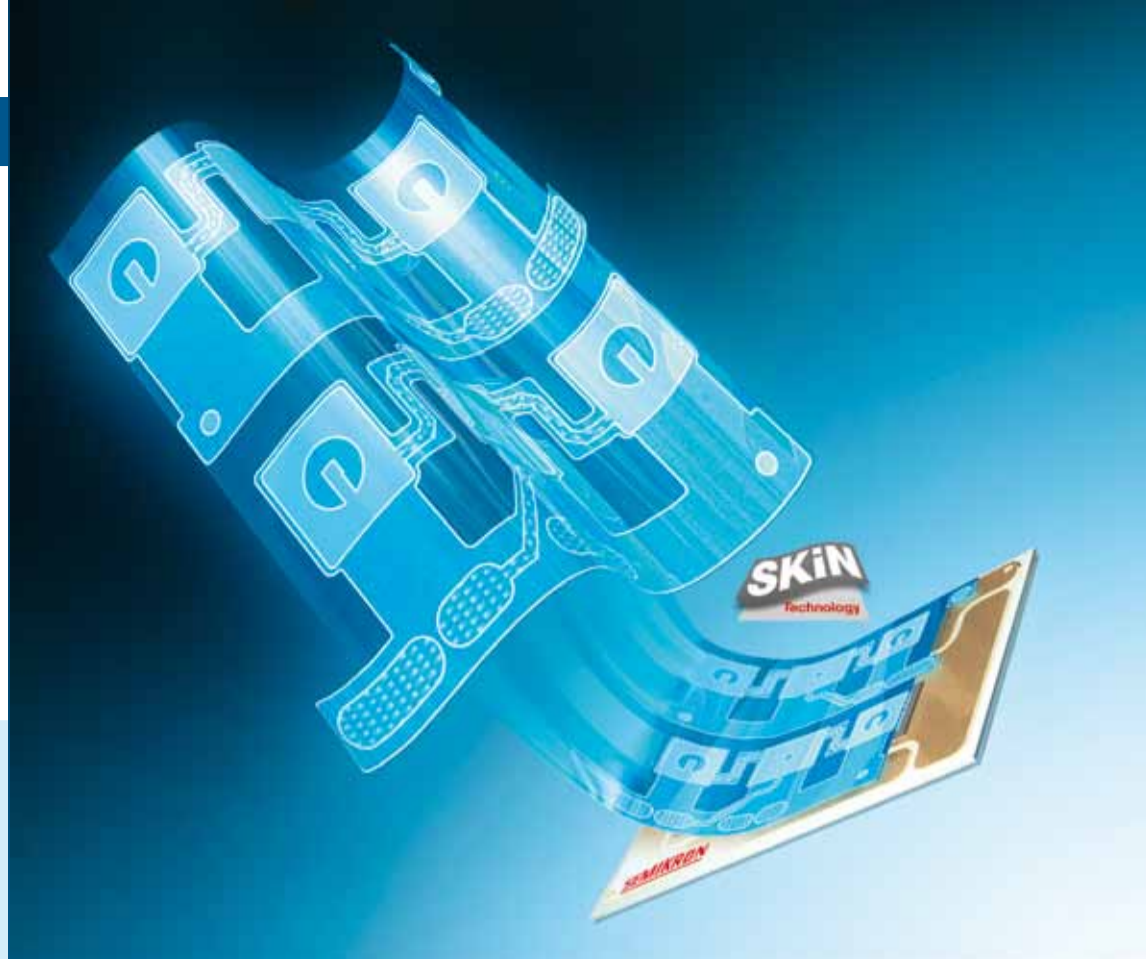
Figuur 1. De SKiN technologie vervangt bondingdraden door een flexibele folie en de soldeerverbindingen en warmtegeleidende pasta door sinterverbindingen.
