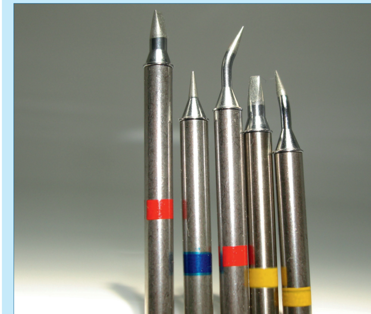
Figuur 1. Het totale verwarmingssysteem zit in de stift ingebouwd (in het gedeelte boven de gekleurde ring). Deze ring geeft daarbij de temperatuur aan. Onder deze ring wordt de stift niet warm.
