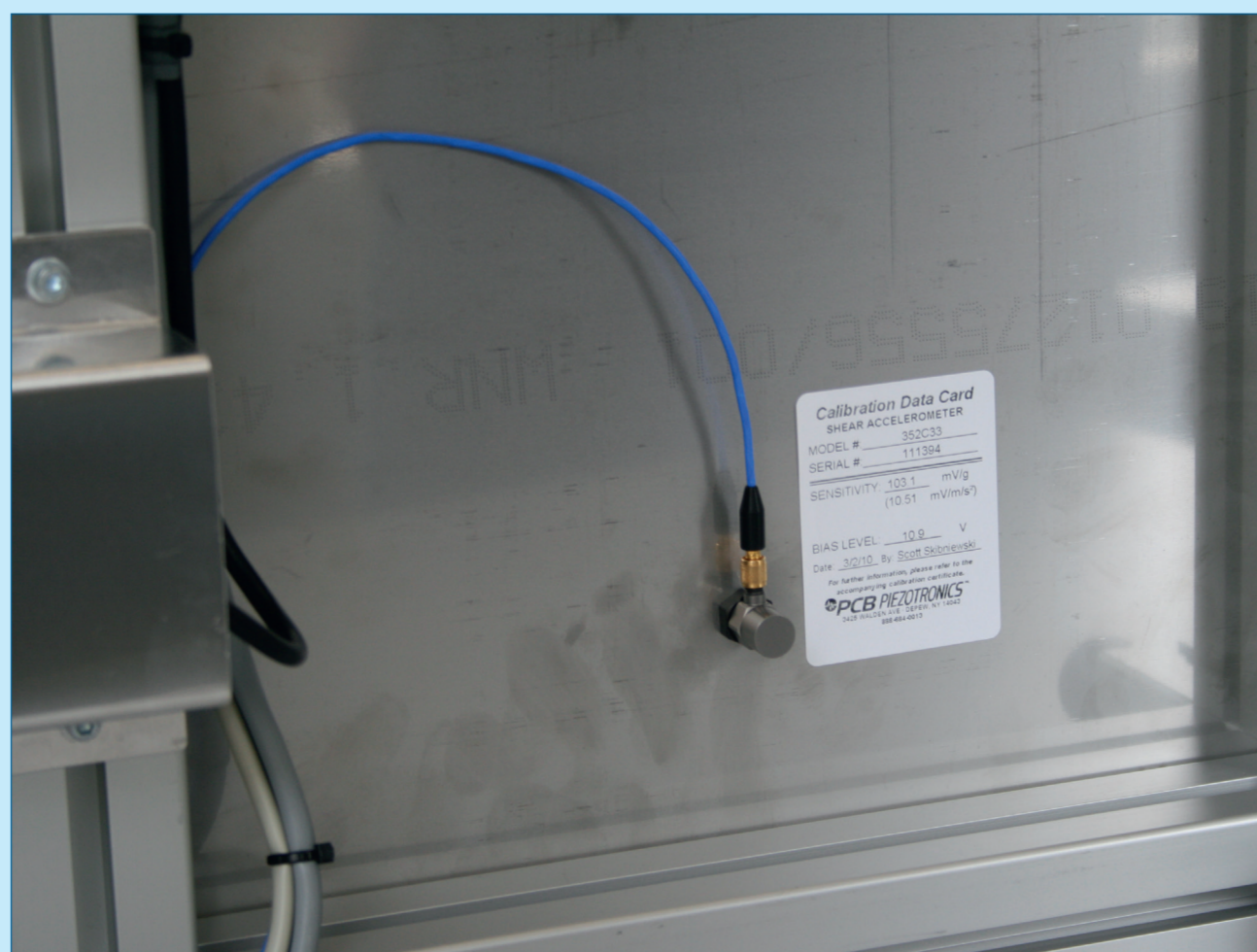
Figuur 2. Met een piezo-sensor onderop de testopstelling kunnen de trillingen van de pomp gedetecteerd worden.
