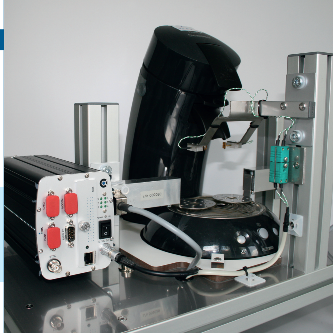
Figuur 1. De door Daqpoint ontwikkelde testopstelling voor Senseo-koffiezetters.
