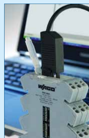
Figuur 1. De modules zijn slechts 6 mm breed.
