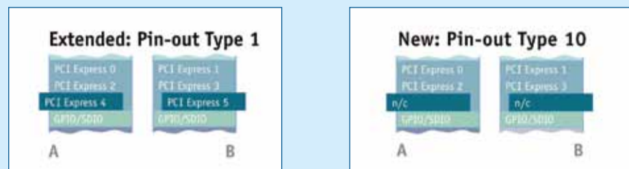
Figuur 2: Bij type 10 blijven de pinnen voor de PCIe lanes 4 en 5 vrij en deze kunnen voor toekomstige technologieën worden gebruikt.
