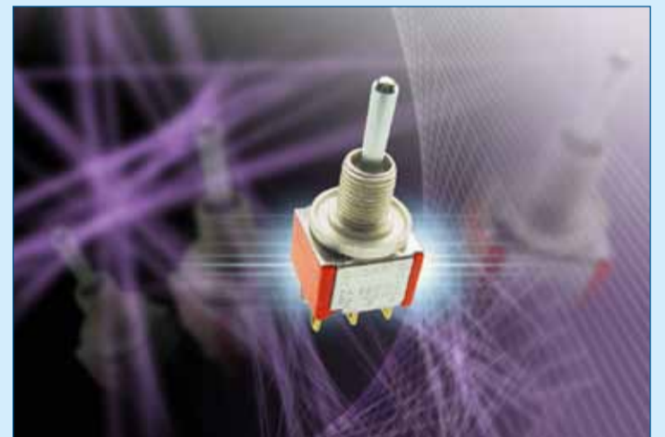
Figuur 2. Door o.a. de behuizing vlamvertragend te maken en de contacten te voorzien van een aanzienlijk laagje goud voldoen deze schakelaars aan de MIL-STD-202 en de MIL-S-83731.
