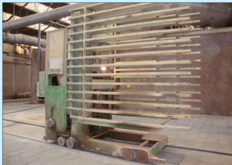
Figuur 1. De kar waarop de gevormde stenen vervoerd worden naar de droogkamer.
