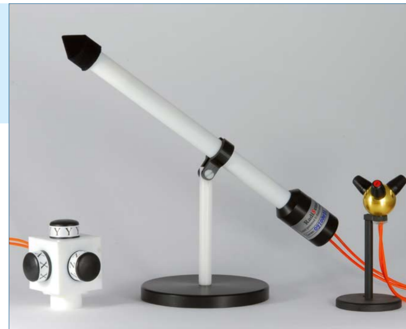
Afbeelding 1. Drie verschillende veldsterktesensoren, elk voor een eigen frequentiegebied, voor het meten van velden van 9 kHz tot 18 GHz.
