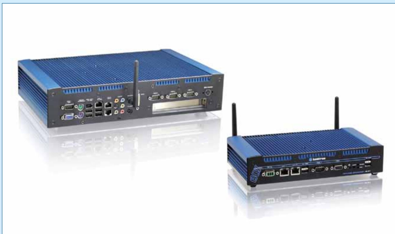
Afbeelding 3: Box-PCs met mini PCIe-kaartconnector voor het flexibel ontwerpen van draadloze netwerken.
