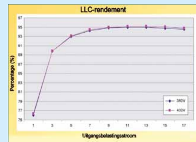
Figuur 4. Rendement over het belastingsstroombereik.
