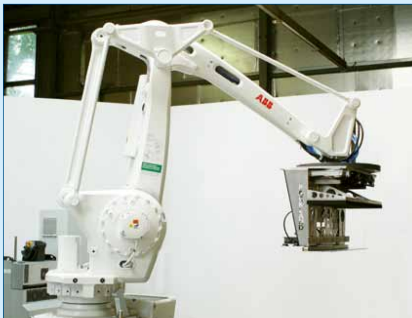
Figuur 2. De slimme robotkop die zowel bussen als emmers kan pakken.
