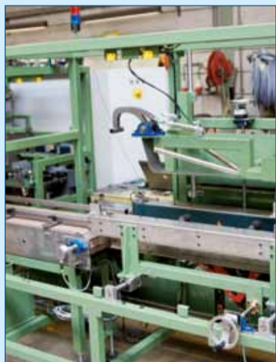
Figuur 1. Alle sensoren zijn aan de bovenkant van de machine geplaatst zodat de kans veel kleiner is dat ze onder de verf komen te zitten.
