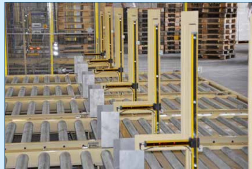
Figuur 3. De lichtschermen van Pilz zijn door het horizontale deel heel gemakkelijk om het verschil te kunnen detecteren tussen een pallet of een mens.
