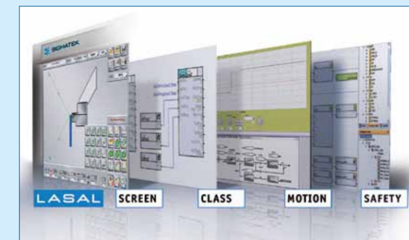
Figuur 2. LASAL beschikt over objectgeoriënteerde programmering met Client-Server technologie en grafische presentatie.
