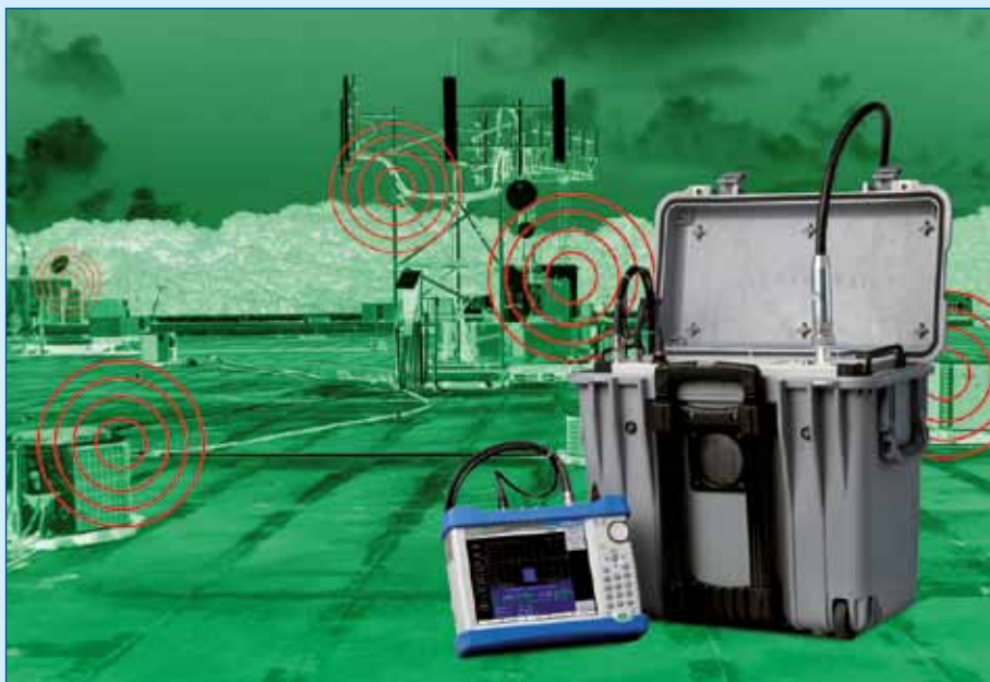
Figuur 3. De Pim Master van Anritsu kan niet alleen de hoeveelheid PIM aantonen, maar kan ook de afstand tot de bron bepalen.
