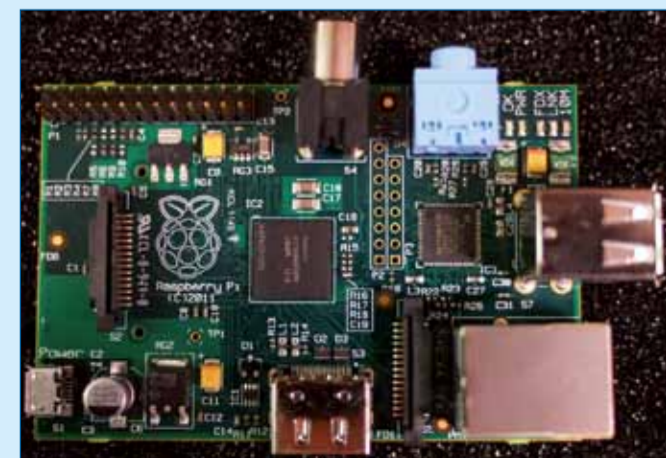
Figuur 1. De print van de Raspberry Pi heeft de afmetingen 85,60 x 53,98 x 17 mm en is daarmee ongeveer net zo groot als een bankpasje.
