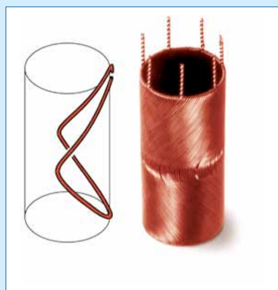
Figuur 2. De rotor bevat geen ijzeren kern. Het enige dat draait zijn de koperen wikkelingen.
