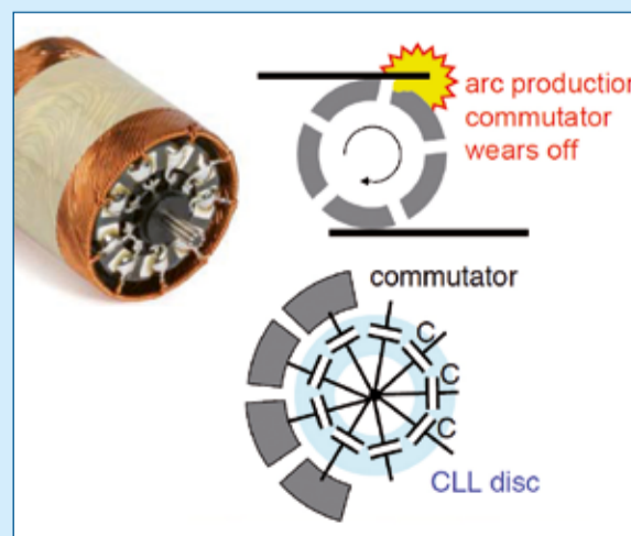
Figuur 4. Door parallel aan de wikkelingen condensatoren te schakelen, wordt vonkvorming verkleind.
