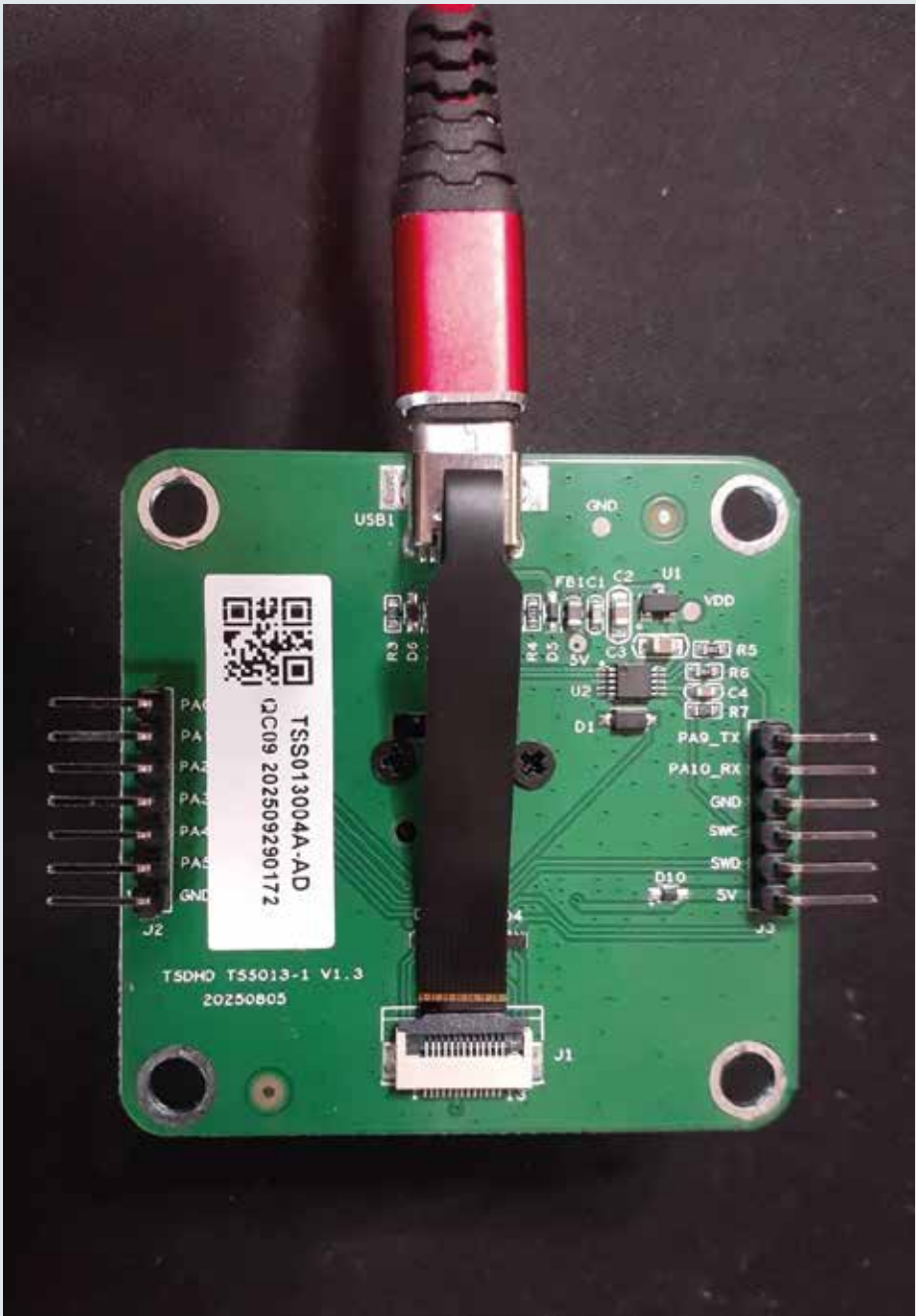
Afbeelding 2. De interfaceprint om bijvoorbeeld de knop op een USB-poort aan te sluiten.
