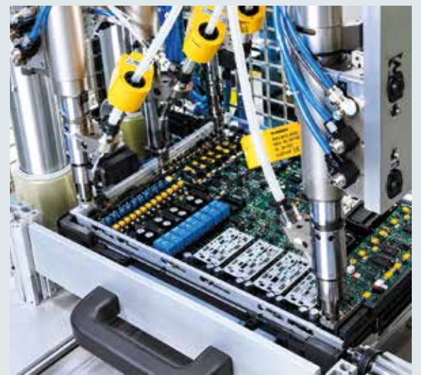
Afbeelding 3. Een voorbeeld waarin ringsensoren zijn toegepast. In dit geval nog de oudere modellen zonder IO-link.
