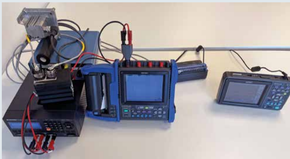
De demo-opstelling van Batenburg waarbij peltier-elementen voor koeling zorgen.
