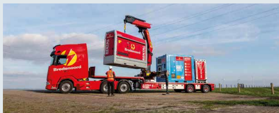
Diesel aggregaat en een modern Battery Energy Storage System van Bredenoord.
